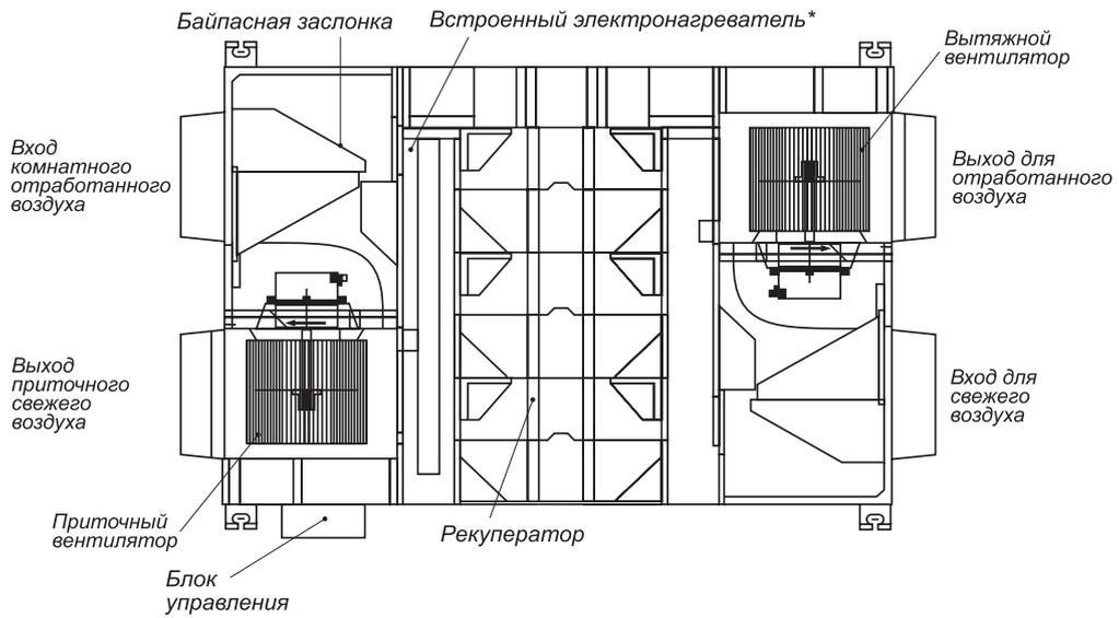
**Приточно-вытяжные компактные установки с АС-двигателем, энтальпийным рекуператором и электрическим нагревателем**
