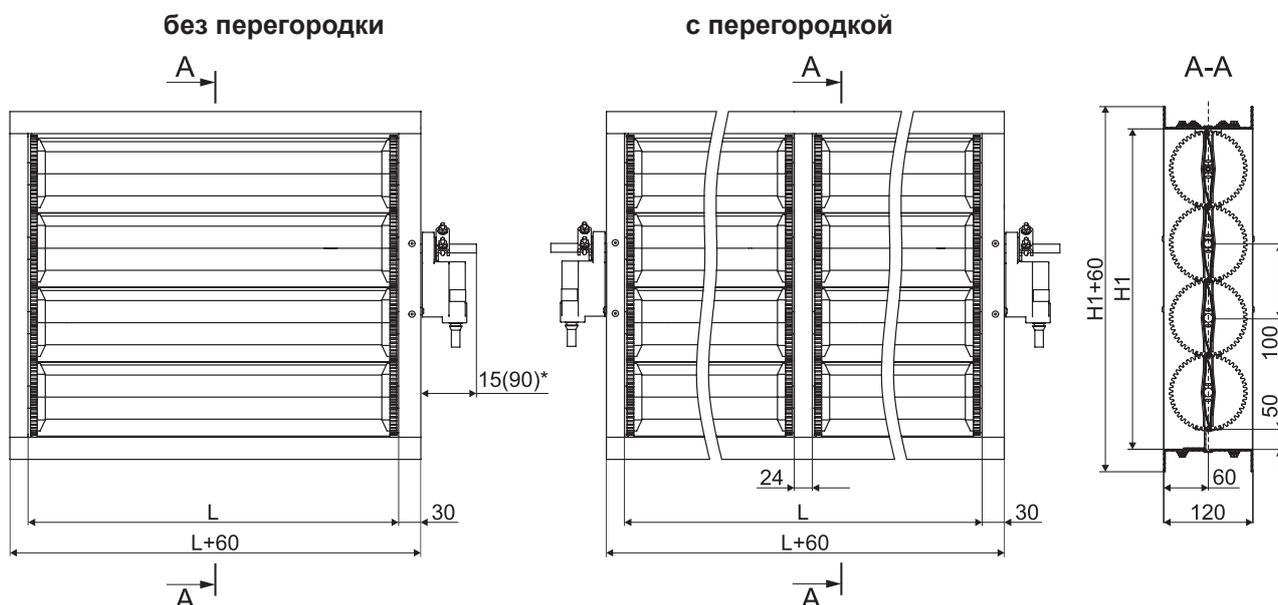
\* Вылет оси: 15 мм - под ручной привод, 90 мм - под электропривод.
