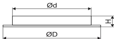
Ø d - диаметр соединительного патрубка
